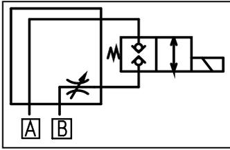
本バルブはLVSH-2シリーズのシャットオフバルブのポート面に積層し、流量調整を行うバルブです。コンパクトで簡易に既存の油圧システムに対応出来ます。
