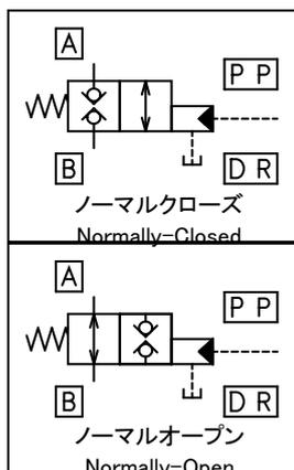
本バルブは空圧及び油圧操作スプリングオフセット型二方向バルブで“ゼロリーク”技術のボールポペット型ピストン構造及び軸推力補償構造を兼ね備えたバルブです。作動油の流れはA/Bポートのどちらからでも良く、常時閉(ノーマルクローズ)常時開(ノーマルオープン)の二つの形式があります。どちらの形式でも“ゼロリーク”で静かな安定作動が得られ耐久性にも富んでいます。
